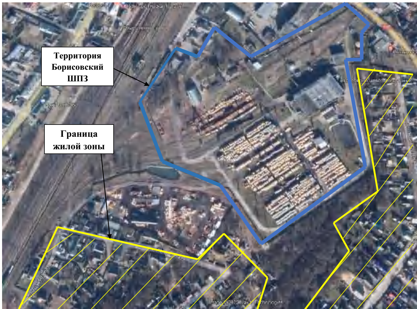
Рисунок 2 – Ситуационная схема Борисовский шпалопропиточный завод
