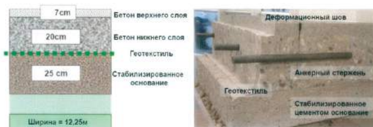
Рисунок 7.4 - Структура устройства автострады
