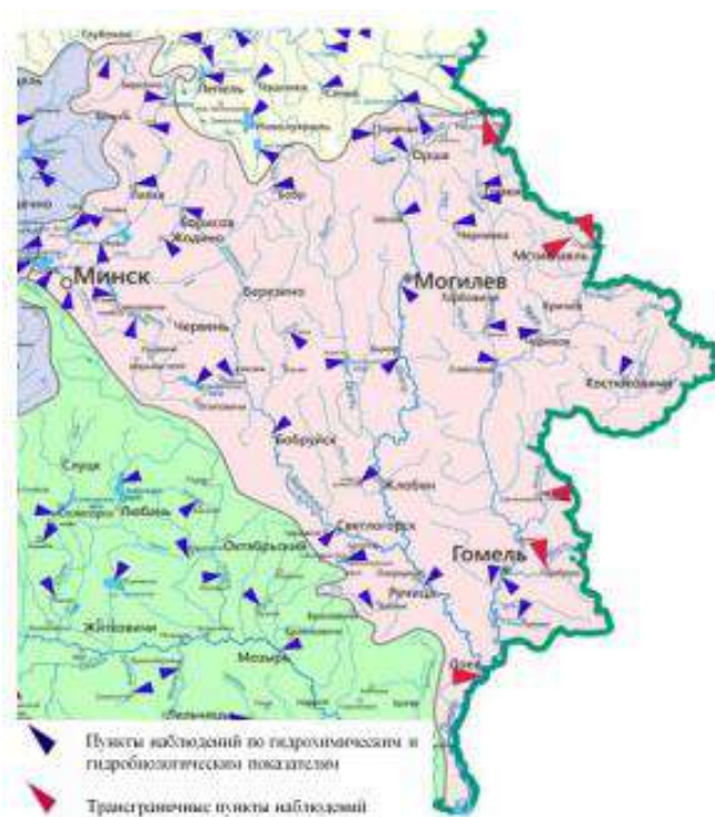
Рисунок 2.3.2 – Схема расположения пунктов наблюдений в бассейне р.Днепр
